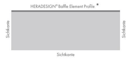
\* Zweilagige Baffle mit HERADESIGN® Deckschicht und eloxiertem Aluminiumprofil auf der Oberseite.
